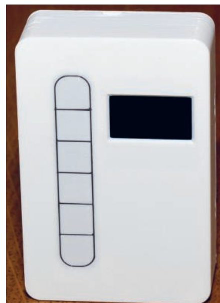
Идеен прототип, прототип и финален продукт на устройство за измерване на въглероден двуокис в помещението
